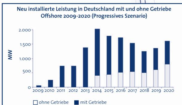
Abbildung 2: Neu installierte Leistung in Deutschland mit und ohne Getriebe Offshore 2009 bis 2020 (Progressives Szenario)
